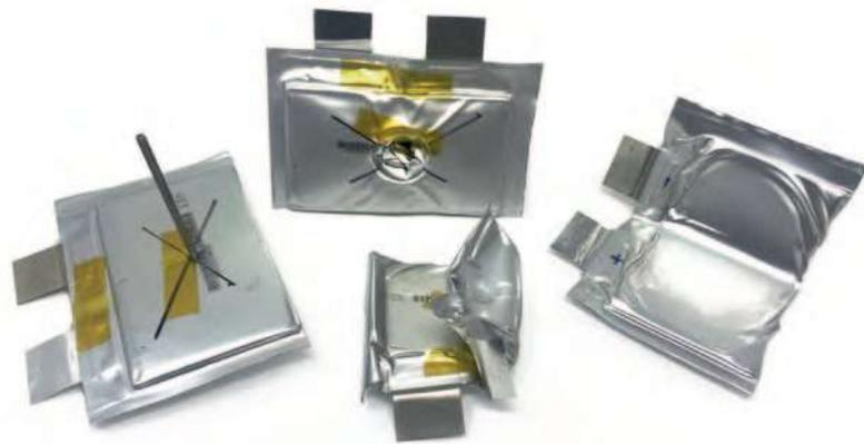
Beschädigte Zellen (Foto: Soteria)
