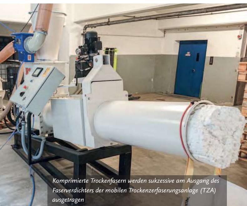
Komprimierte Trockenfasern werden sukzessive am Ausgang des Faserverdichters der mobilen Trockenzerfaserungsanlage (TZA) ausgetragen
