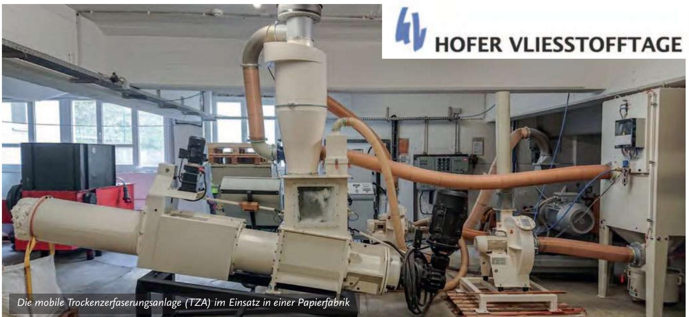
Die mobile Trockenzerfaserungsanlage (TZA) im Einsatz in einer Papierfabrik
