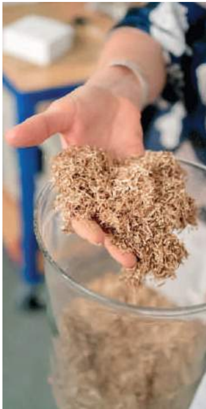
Das Häckselgut aus Hopfen, Hanf (hier im Bild) und Miscanthus soll zum Rohstoff für die spätere Papierherstellung werden (Foto: Alexander Ratzing)
