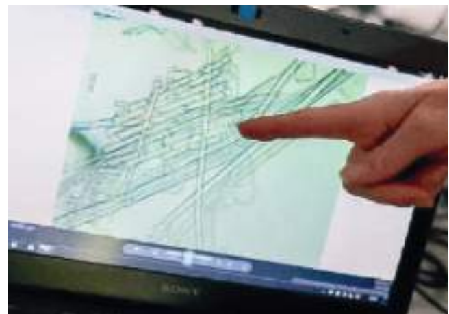
Je länger und unverbundener die Fasern, desto geeigneter ist der gekochte Rohstoff für die Zellstoffproduktion (Foto: Alexander Ratzing)
